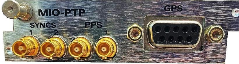
MIO-PTPは、非常に柔軟な小型フォームファクタのPTPおよびベースバンドタイミングソリューションです。アナログ同期および/またはPTPの基本要件が求められる小規模タイミングシステムの核となることができます。他の用途では、ハイブリッドタイミングシステム向けのラック上部設置型PTP同期パルス発生器として展開可能であり、分配増幅器からなる独立したベースバンド分配ネットワークを設置する代わりにアナログ基準タイミング信号を提供します。また、GNSSアンテナ設置が許可されていない会場やアリーナにおいて、管理対象IPネットワーク経由でタイミングを拡張する用途にも展開可能です。
