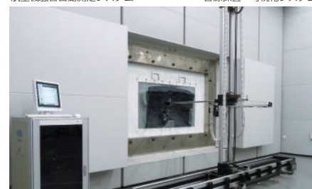
自動車防音材の性能評価システム
