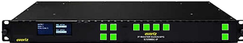
5700MSC-IPは、GPSやGLONASSを基準としたIPネットワークグラウンドマスタークロックでありビデオマスターシンクジェネレーターです。このシステムは、2個のGbE、2個の10GbEポート、6個のフルタイム同期出力、4個のSDI出力とループスルー基準入力を備えています。LTC出力やAES/アナログオーディオのテストセットが必要な場合には、オプションで(+AUX)拡張モジュールが用意されています。
