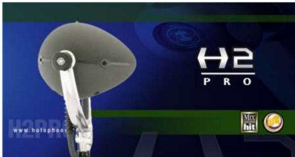
ラグビーボールを一回り小さくしたようなコンパクトボディに、コンデンサーマイクを8個マウントしたワンポイントサラウンドマイクです。搭載マイクの組み合わせにより、5.1ch、6.1ch、7.1chの収録に対応。スポーツ中継、映画、ドキュメンタリーなどで多く使用されています。マイクはレフト、ライト、センター、レフトサラウンド、ライトサラウンド、センターリア、トップ、ローそれぞれに搭載しています。
