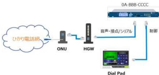
Dial Assist Pad Controller(Dial Pad)はひかり電話回線対応のAPT IP CODEC専用のリモートコントローラです。タッチパネルを使用してダイヤル発信や電話帳機能を使った発信ができます。1台で最大8台までコントロールできます。
